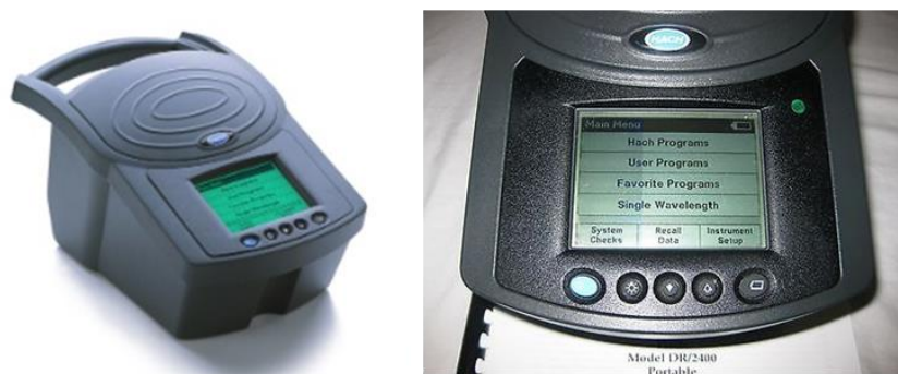
Figura 4.43 - Espectrofotômetro portátil (Hach DR/2400) para medição dos parâmetros in situ : azoto amoniacal, nitratos, fósforo total.
