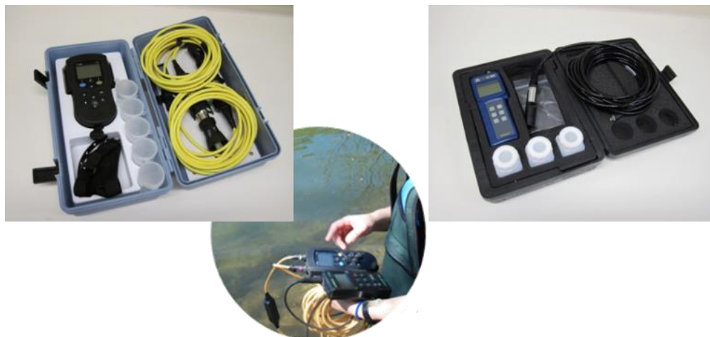
Figura 4.42 - Sondas para medição dos parâmetros in situ : HACH HQ40d à esquerda e YSI EC200 à direita
